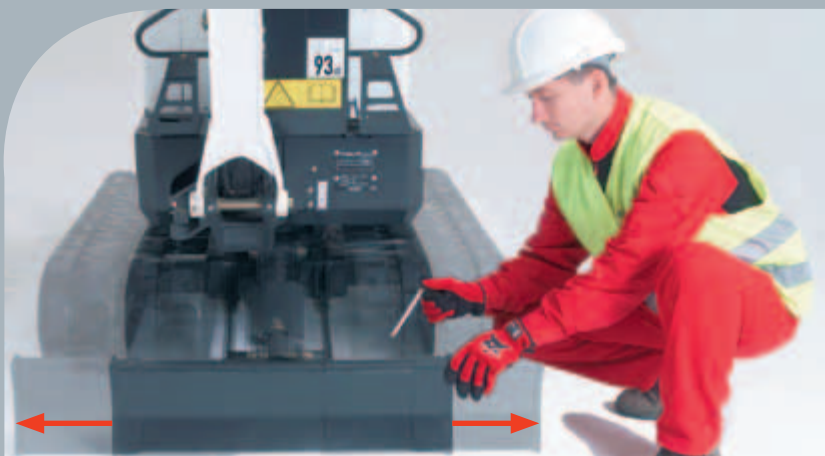
Der E08 und E10 sind serienmäßig mit verstellbarem Unterwagen und ausziehbarem Planierschild ausgestattet. Der Ab- und Anbau der Schild-Verbreiterungen entfällt.
